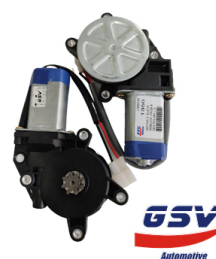
MOTOR V. ELETR. MABUCHI 8 DENTES 24VOLTS PAR
