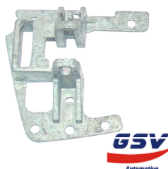
SUPORTE DO REVESTIMENTO, DO GATILHO DA MAÇANETA DO GOL GIII, EM ZAMACK, PARTE
